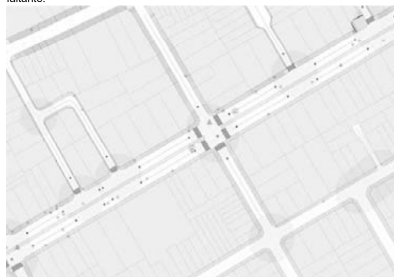
Figura 5 - Exemplo de um trecho da base de travessias levantadas ao longo dos 430 km de vias principais. Os pontos de interseção entre o eixo do leito e a área de influência da interseção representam a quantidade de aproximações que potencialmente seriam contempladas por travessias. Elaboração: Instituto Cordial em parceria com WRI Brasil.
